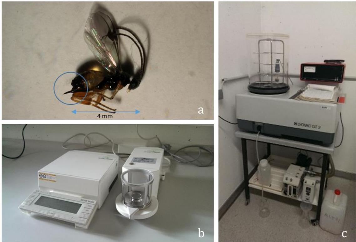
Abbildung 5: (a) Weibliche Wespe mit Ovipositor (blauer Kreis), (b) Mikrowaage (Mettler Toledo, MT5), (c) Lyophilisator (Lyovac GT2)
