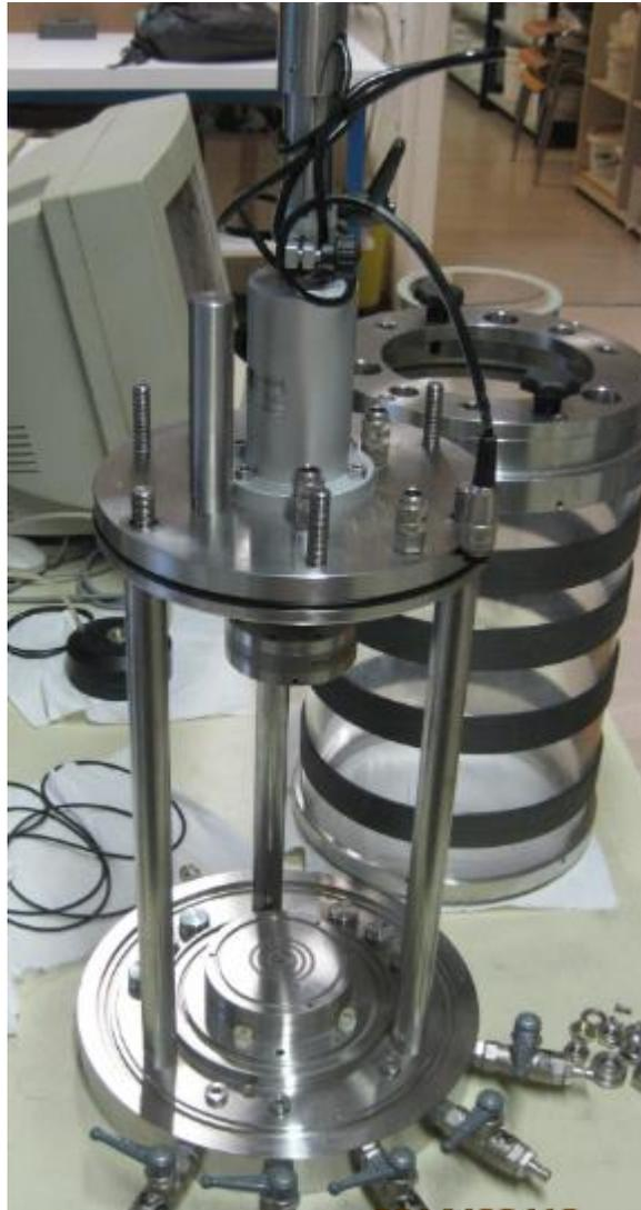
Abbildung 24: Triaxialprüfzelle
