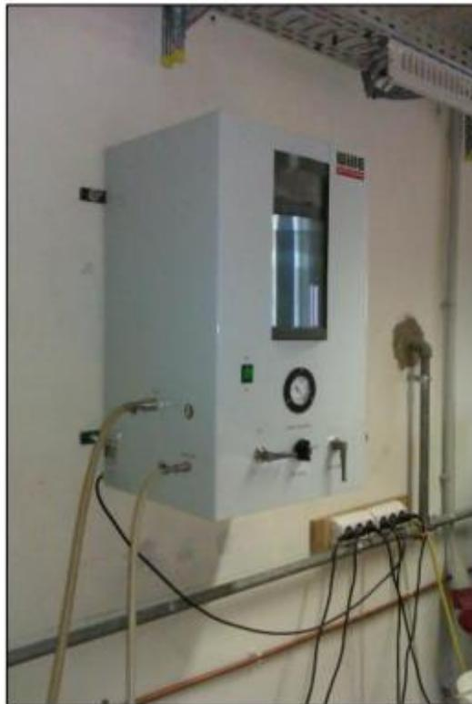
Abbildung 23: Wasser-Entgasungsanlage (Schöfer, 2012)
