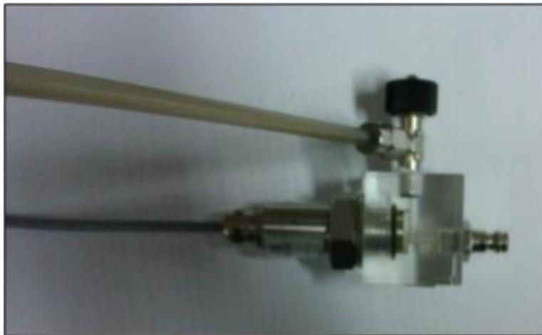
Abbildung 25: Porenwasserdrucksensor (Schöfer, 2012)
