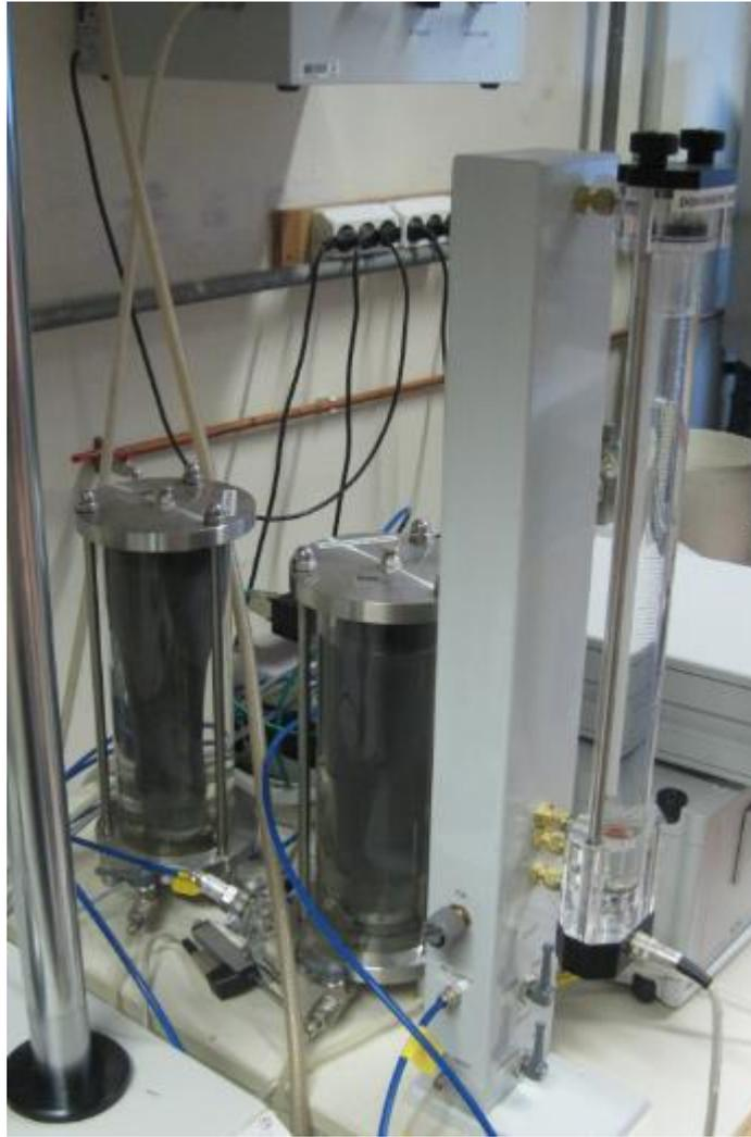
Abbildung 22: Druckluft-Wasser Zylinder und Volumenmessenrichtung
