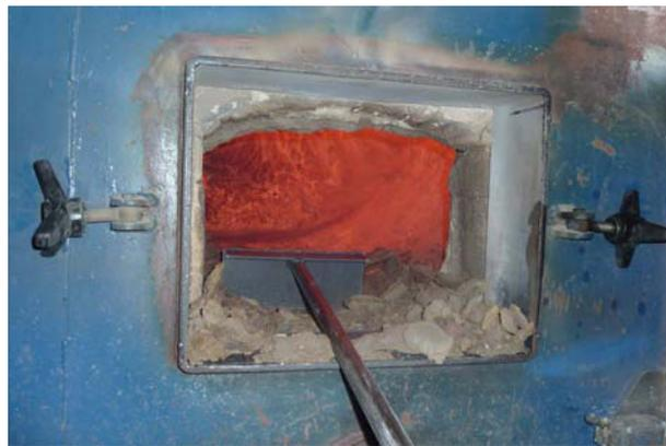
**Abbildung 2.2:** zur Entaschung gerade geöffnete Feuerkammer
