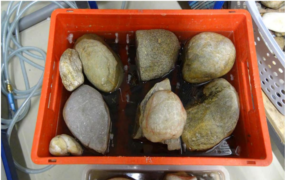
Abbildung 28: Wasserlagerung der Probekörper
