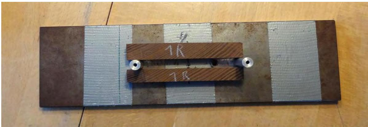
Abbildung 52: Messvorrichtung zur Ermittlung der Verschalung mittels Mittelschnitttest
