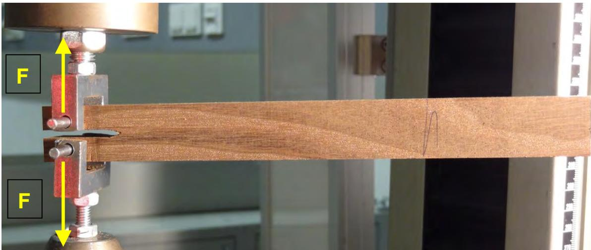
Abbildung 24: Probekörper in der Prüfmaschine vor der Prüfung
