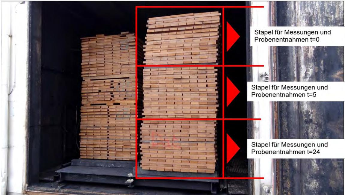
Abbildung 11: Brettstapel in der Behandlungskammer des Unternehmens Mitteramskogler GmbH, die für die Untersuchung des derzeitigen Abkühlungsprozesses herangezogen wurden
