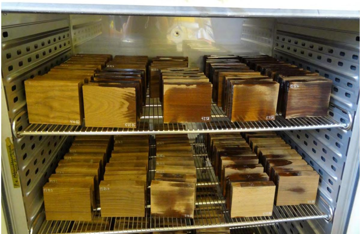
Abbildung 29: Probekörper im Darrschrank
