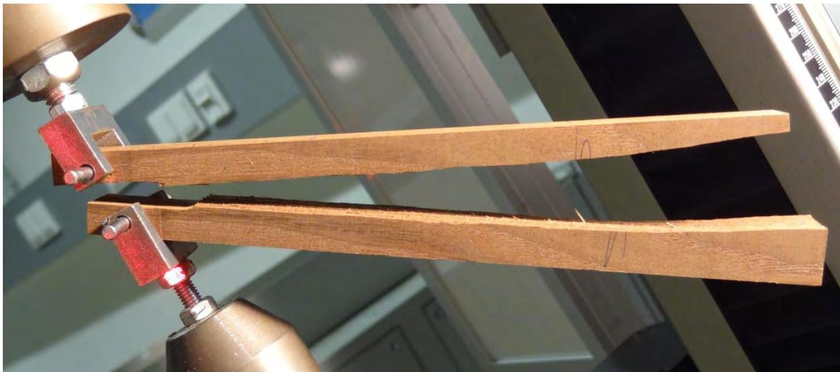
Abbildung 26: Probekörper in der Prüfmaschine nach der Prüfung
