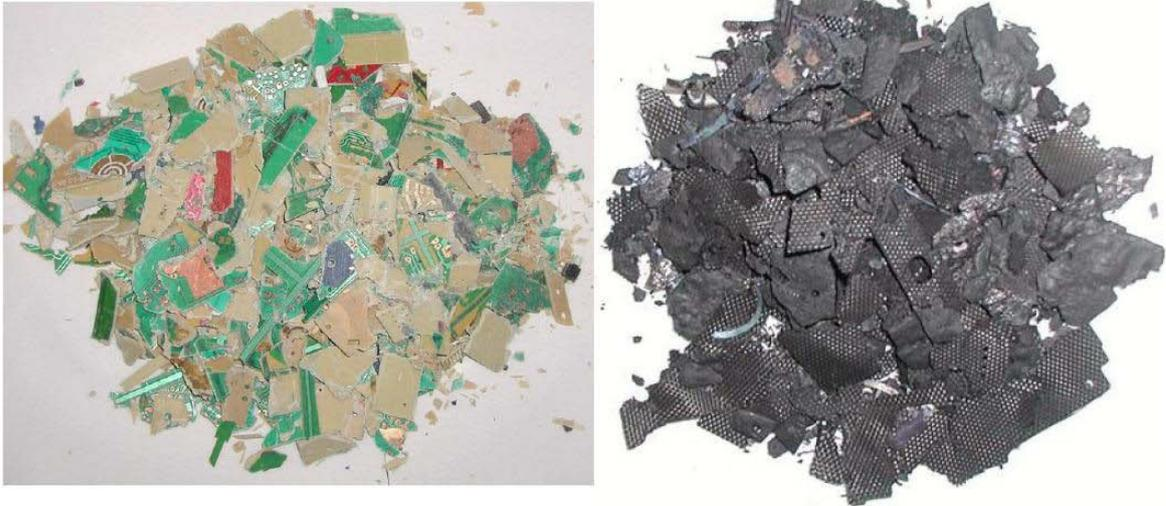
Abbildung 27: Zerkleinerte Leiterplatten und Rückstände nach zweistufiger Pyrolyse (KOCH, 2007)
