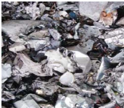
Abbildung 3: Austragsgut nach dem Schreddern – Eisen (BHS, 2012)
