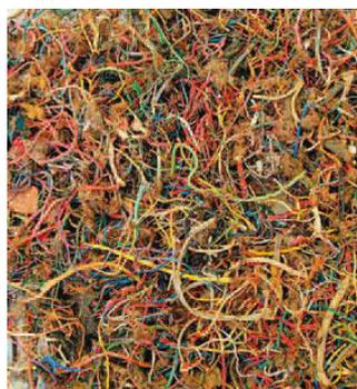
Abbildung 23: Ergebnis der Sortierung mit Kabelrückgewinner (TITECH, 2012)
