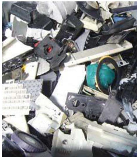
Abbildung 5: Austragsgut nach dem Schreddern – Kunststoffe (BHS, 2012)
