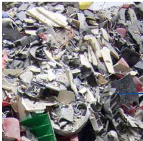
Abbildung 2: Austragsgut nach dem Schreddern (BHS, 2012)
