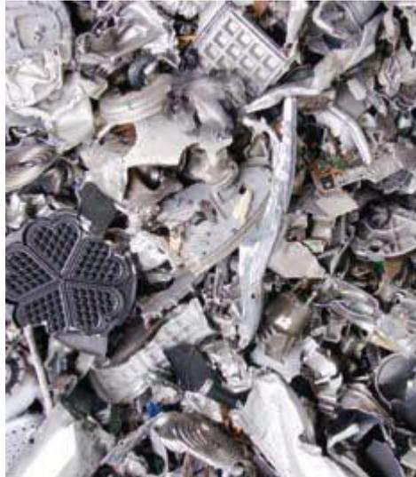
Abbildung 4: Austragsgut nach dem Schreddern – Nichteisenmetall (BHS, 2012)
