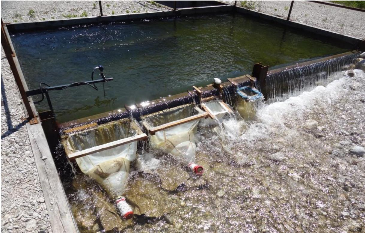
Abb. 6: Tosbecken mit darin befindlicher Prallwand; Planktonnetze (Quelle: eigene Aufnahme, 13/06/2013)
