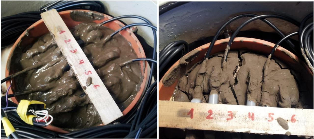
Abbildung 18: Schrumpfrisse durch Entwässerung
