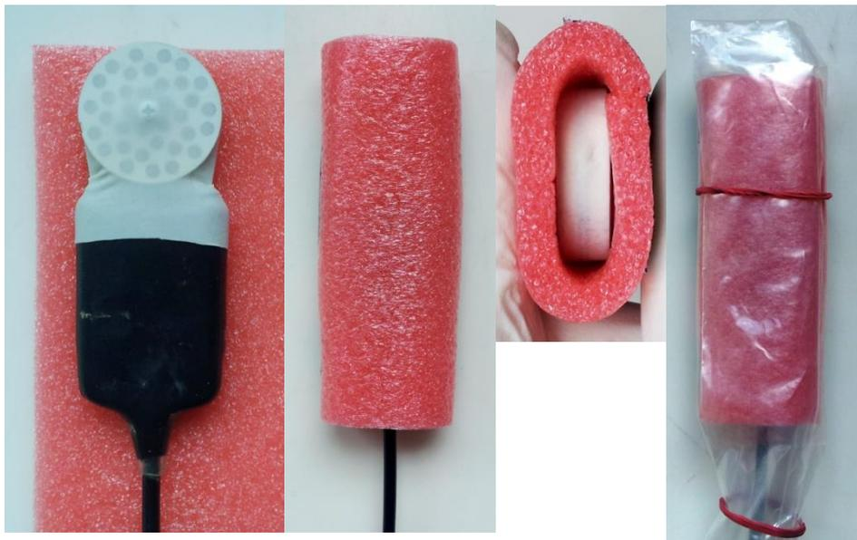
Abbildung 12: Gummihülle, Schaumstoffmantel, Kunststoffhülle
