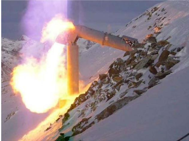
Abb. 5-1: Gazex-Zündrohr bei einer Zündung (Quelle: Interfab Snowbusiness GmbH (o.J. a))
