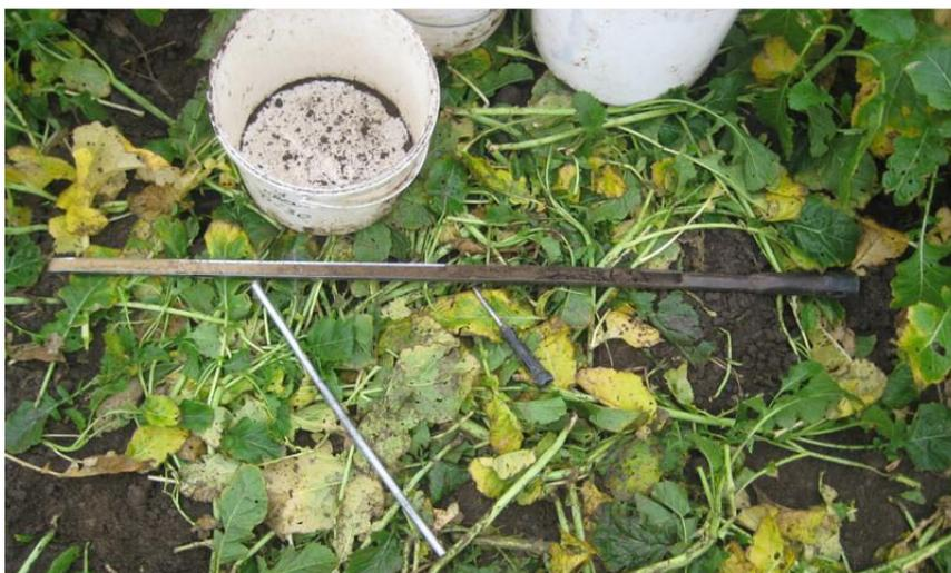
Abb. 10: Bohrstock mit Boden-Probenmaterial von 0 bis 90 cm Bodentiefe
