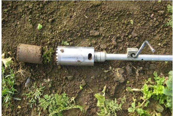
Abb. 12: Probe und Wurzelbohrer
