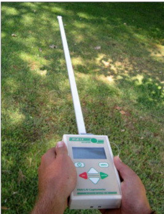
Abb. 9: LP-80 Accu PAR – PAR/LAI Ceptometer: (ROSELL und SANZ, 2012)
