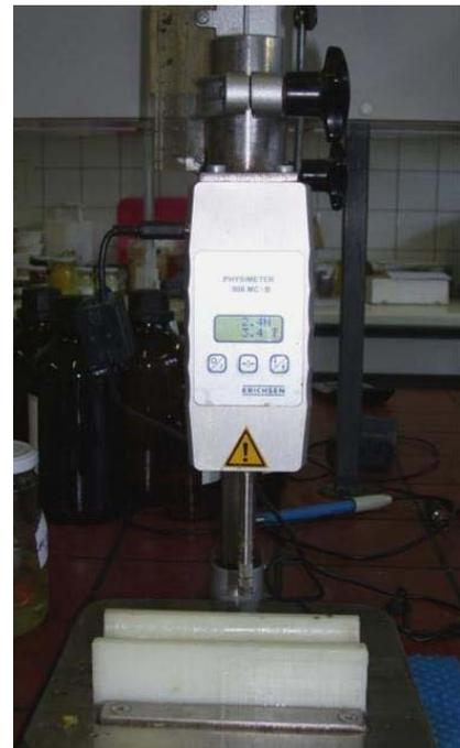
Abb. 11: Penetrometer
