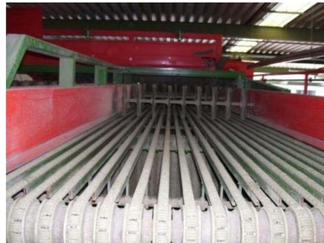
Abb. 2: Kettensortiermaschine
