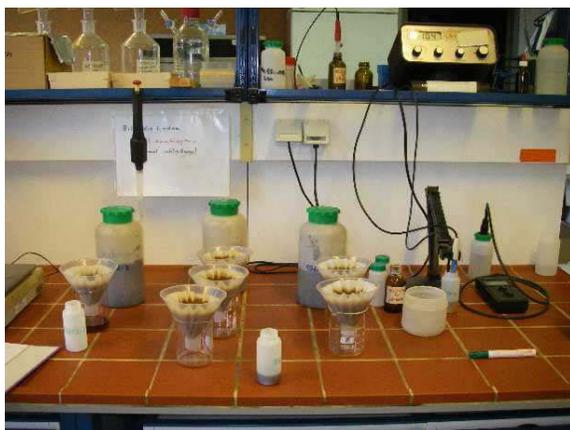
Der pH-Wert wird aus dem Eluat der frischen Laborprobe bestimmt.
