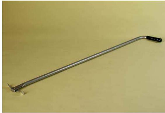
Abbildung 18: Sperre zwischen oberen und unteren Bereich der Haupttrottekammer
