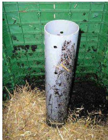
Abbildung 25: Solarkomposter mit gelochtem Zentralrohr zur Warmluftverteilung, Klostersaler Umwelthütte, Quelle: SCHÖN, 2007
