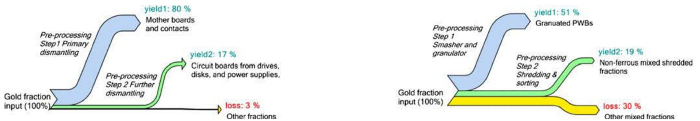
Abbildung 10: Szenario 1 (links): Manuelle Demontage von PCs in Deutschland (Meskers und Hagelüken, 2009); Szenario 2 (rechts): Mechanische Aufbereitung von PCs in Deutschland (Meskers und Hagelüken, 2009)
