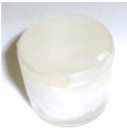
Abbildung 7: Kunststoffbecher mit Coating zur WVP-Messung
