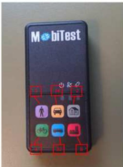
Abbildung 67: Aufnahmegerät; mit Hilfe der einzelnen Knöpfe wurden die Fahrzustände protokolliert.
