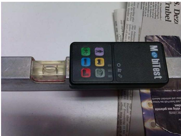
Abbildung 9: mit der Wasserwaage horizontal ausgerichtetes Messgerät
