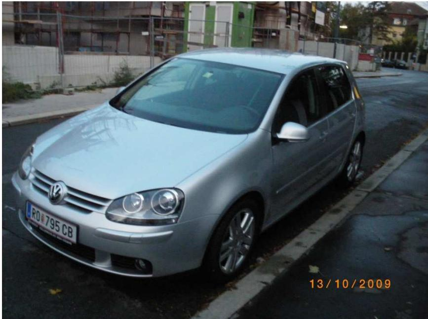
Abbildung 3: Versuchsfahrzeug VW Golf V 77 kW (105 PS) TDI
