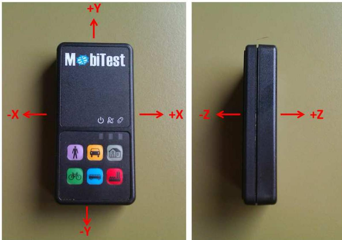
Abbildung 2: Messrichtung des Beschleunigungssensors
